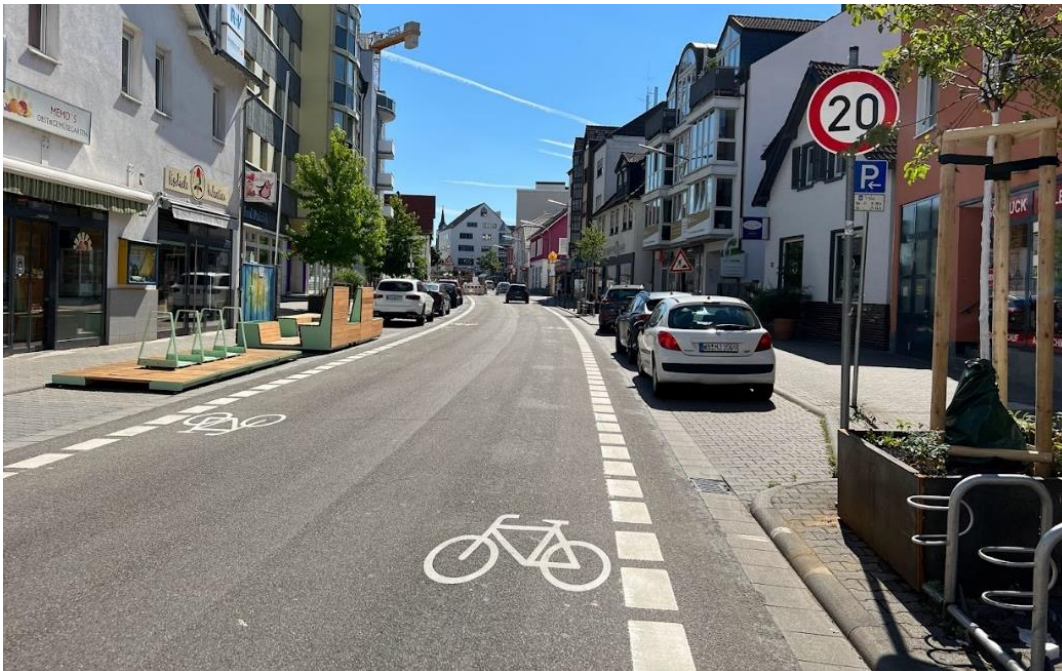
Abbildung 24 – Mischverkehr in Verbindung mit zulässiger Höchstgeschwindigkeit 20 km/h, Beispiel aus der Bahnstraße in Langen; Foto: VAR+ ©
