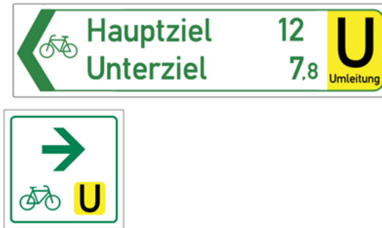
Abbildung 33 – Beispiel einer Umleitungsbeschilderung (FGSV, 2024)
